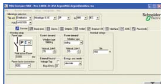
RSU (Remote Setting Utility): program do zdalnego ustawiania zabezpieczeń Micrologic
