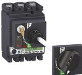
Wyłącznik Compact NSX z napędem obrotowym przedłużonym, zamontowany na tylnej płycie rozdzielnic, z możliwością założenia blokady z kluczem.
